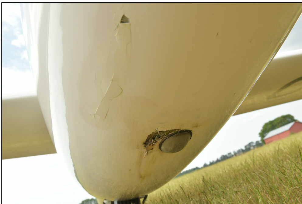
Foto nr. 1. Skade på undersiden af svæveflyet.
