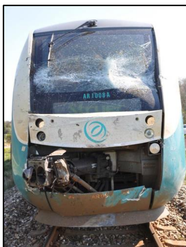
Skader på togsættets front.
