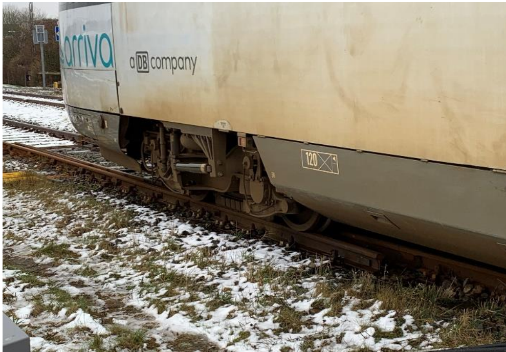
Togets bageste bogie var efter standsning fortsat på sporet. Foto: Arriva.
