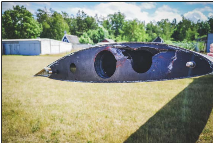
Den beskadigede højre tip-rip
