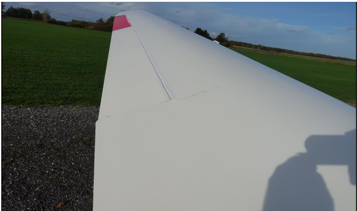
Ca. 170 mm lang revne i skindet på venstre vinges over- og underside (OY-XDL).
