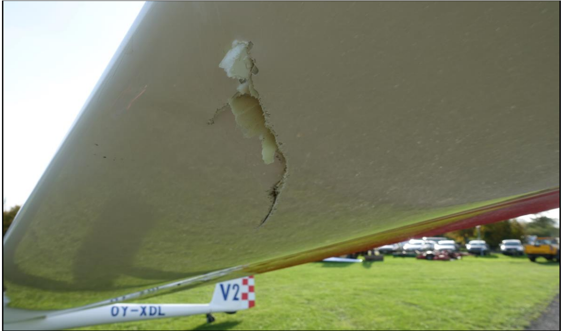
Ca. 300 millimeter (mm) lang punktering af yderste del af venstre vinges underside (OY-XDL).
