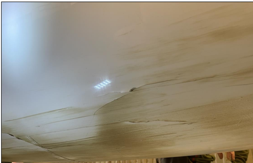
Foto 1: Strukturelle skader på bunden af svæveflyet
