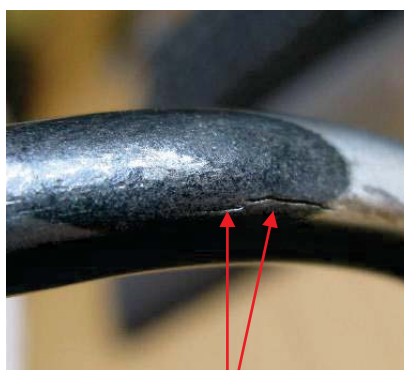
Slidtage og revner i trykrør
