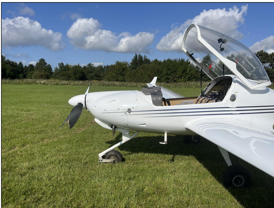
Foto 1. Skader på motorsvæveflyets propel og næsehjulsunderstel.
