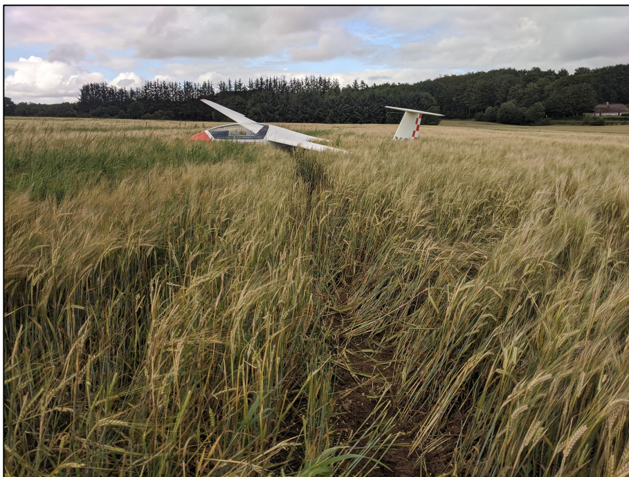
Foto 1. Svæveflyet i kornmarken efter et ground loop. Kornafgrøden var ca. 0,5 meter høj.
