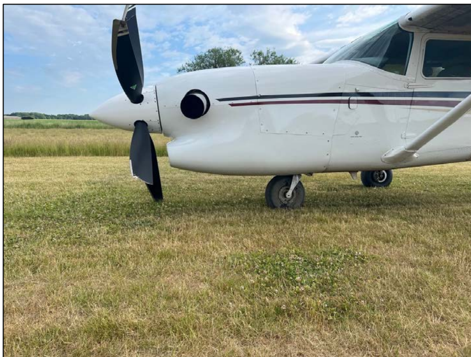
Foto 1. Skader på propellen og det kollapsede næsehjulsunderstel.
